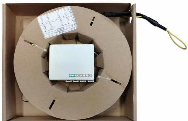
**Caja de Terminación Óptica de Plástico para Apartamentos**, preconectorizada por ambos lados, con 4 conectores SC/APC y disparador; disponible con 100 m de cable de 4 fibras para sistemas FTTH multiservicio; una solución muy útil para integrar todos los servicios centralizados en la CSOE de los sistemas FTTH en cada vivienda individual.
